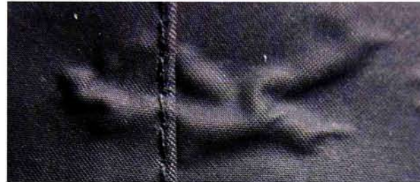
樹脂の劣化による表地が剥がれてブクついた
