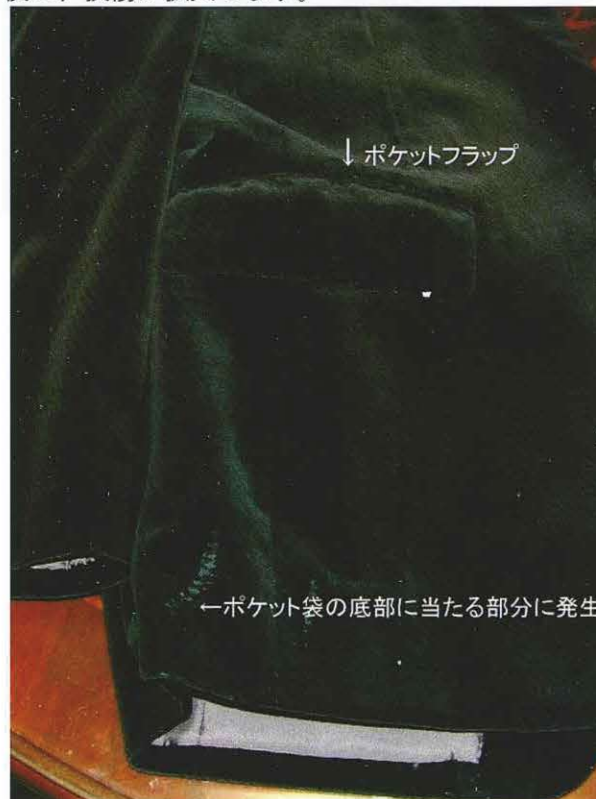
ポケット底辺部に発生したパイル抜け
